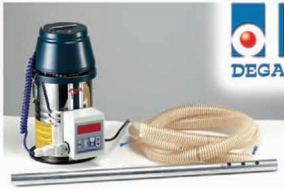
Alimentatore di additivi in granuli o microgranuli costruito in acciaio inox traslucido, capacità di alimentazione 25/30 kg l'ora.
